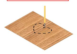
糸鋸の下ねじは固定のまま、あけた穴に 刃を通し、上のねじ取り付けてから切る
