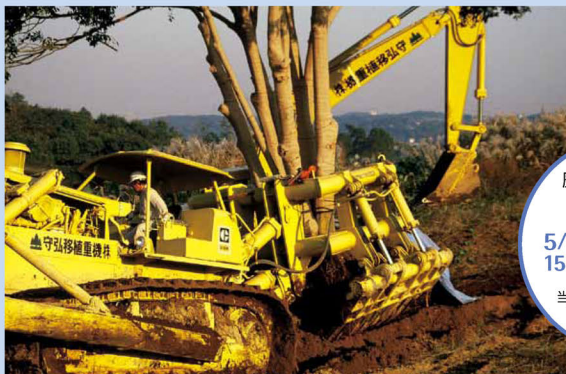
←キャタピラーD9Hと特殊アタッチメントによる移植工事 昭和62年撮影 / 大石武朗撮影・提供
